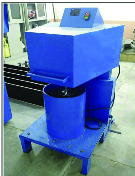
1 Сурет - ASTM C1138 сәйкес қажалуды сынау үшін қолданылатын машина
